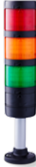
Artikel-Nr.: PC7-Q06 Farben: rot-orange-grün Funktion: LED Multifunktions-Modul (rot) + LED Dauerlicht Nennspannung: 24 V AC/DC Montageart: Rohrmontage (100 mm Rohrlänge)
