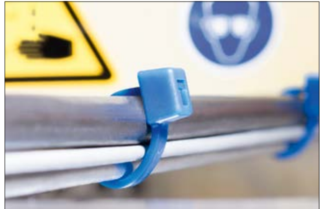
E/TFE Kabelbinder der T-Serie für den Einsatz bei erhöhten chemischen Anforderungen und Temperaturen bis +170 °C.
