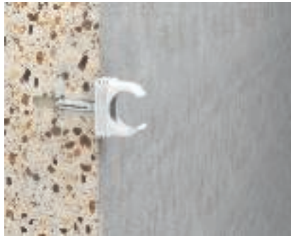
Anwendung Schlagdübel 910/SD-Q Durch die Spreizung des Dübels sitzt die Schelle fest auf der Wand oder unter der Decke.
