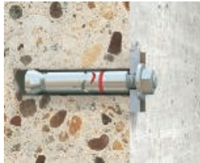
Schwerlastanker Typ FH Schwerlastanker Typ FH mit Gewindeanschluss M12 zur Befestigung von Bauteilen mit großen Belastungen, Tragfähigkeit 8,26 kN.
