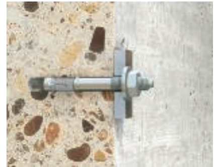
Ankerbolzen Typ FAZ II Ankerbolzen Typ FAZ II, zur Befestigung von Schwerlastverankerungen in bewehrtem oder unbewehrtem Normalbeton C20/25 bis C50/60, für Durchsteckmontage geeignet, mit Anschlussgewinde M8, M10 oder M12, Tragfähigkeit 4,3 kN (M8), 7,6 kN (M10), 11,9 kN (M12). Geeignet für den Funktionserhalt.
