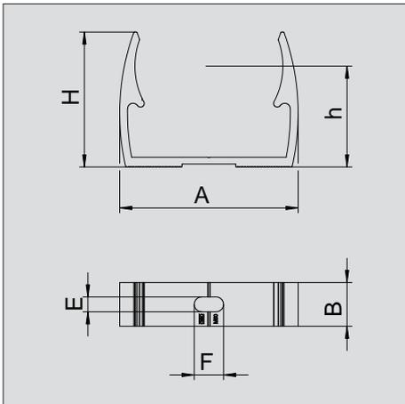
OBO Quick-Schelle Typ ALQ M, für alle metrischen ALU-Rohrsysteme sowie leichte und schwere Isolierrohre. Geeignet zur Aufnahme des OBO Rohrsystems, Werkstoff: ALU. Rohrzentrierhilfen ermöglichen ein optimales Einbringen des Rohres und verdrehen automatisch die Schelle in die richtige Position. Langloch zum seitlichen Ausrichten bei Montage mittels Holzschraube oder Schlagdübel. Empfohlener Befestigungsabstand 50-60cm.
