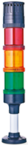
Artikel-Nr.: ECO60-Q31 Farben: rot-orange-grün Funktion: LED Dauerlicht, Summer Dauer- oder Pulston Nennspannung: 24 V AC/DC Montageart: Rohrmontage (100 mm Rohrlänge)
