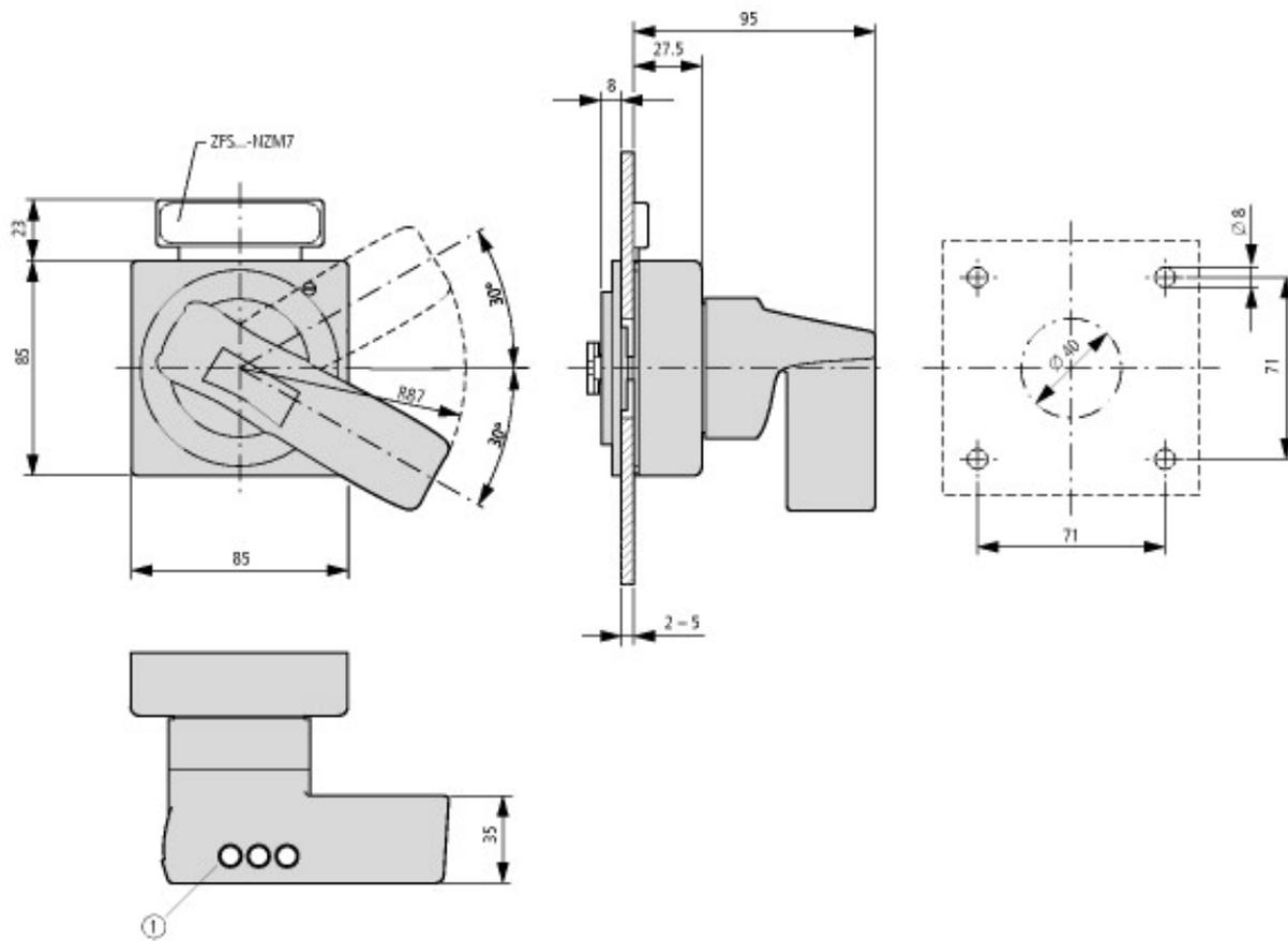
maximale Achslänge 60 mm
