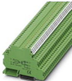
Leistungs-Solid-State-Relaisklemme, Eingang: 24 V DC, Ausgang: 3-30 V DC/3 A, Klemmenbreite 6,2 mm
