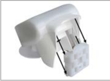
Abb. 14 Schieben Sie das Gehäuse von oben in den montierten Halter. Die Zapfen des Halters müssen dabei in den Schienen des Gehäuses einrasten.
