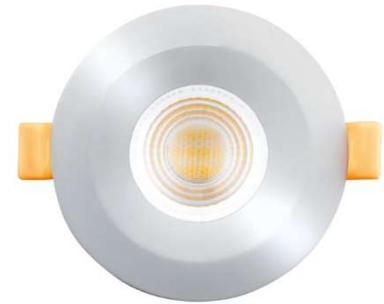
Der LED Spot 68FP ist eine mit gebündeltem, nicht direkt an die Netzspannung angeschlossene Lichtquelle (DLS/NMLS). Das Produkt benötigt zum Betrieb ein separates 350mA Konstantstrom Betriebsgerät. Dieses Produkt hat den 90-minütigen Feuerschutztest gemäß BS 476-21:1987 bestanden (Entspricht der Norm DIN EN 1365-2:2014).
