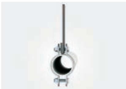
Lastfall 10: Bandende an Rohrschelle angeschraubt, Bandende doppelt Mindestbruchlast nach Spalte A
