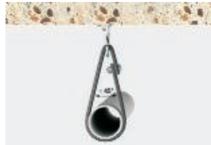
Lastfall 6: Band um Flachöse und Rohr oder um Vergleichbares geschlungen Mindestbruchlast nach Spalte 2xB
