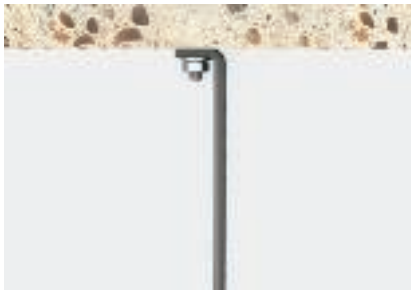
Lastfall 4: mit Schraube und Unterlegscheibe unter die Decke geschraubt Mindestbruchlast nach Spalte C
