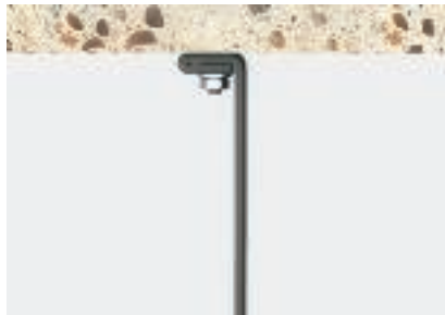
Lastfall 5: mit Schraube unter die Decke geschraubt, Bandende doppelt, freies Bandende nach unten Mindestbruchlast nach Spalte B
