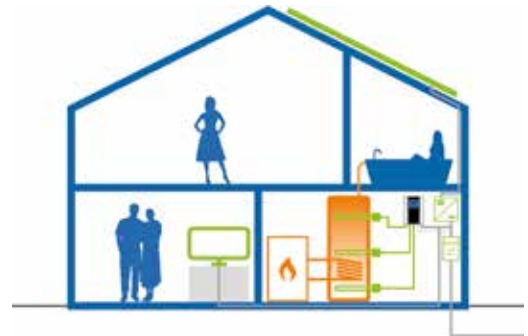
Einfachste Beladung von drei Zonen 3 x 3 kW
